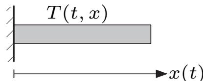
Tale sistema è descritto da una equazione del tipo  $\frac{\partial T(t, x)}{\partial t} = k_1 \frac{\partial^2 T(t, x)}{\partial x^2} + k_2 (T(t, x) - T_a)$ , dove  $T_a$  è la temperatura ambiente.
